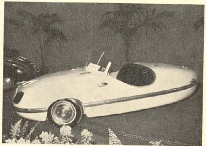
Das ist „Spats“, der 200-ccm-Dreirad-Brütsch mit Plastikkarosserie. Er erregte auf der Ausstellung erhebliches Aufsehen und stellte seine größeren Brüder, den 400-ccm-Plastik-Brütsch sowie den 1200-er-Plastiksportwagen mit dem Taunus-12-M-Motor in den Schatten. Der „Kleine“ besitzt einen Einzylinder-Zweitakt-Sachsmotor mit 15 PS. Motor und Triebwerk hängen in Plastikschalen. Länge 3,3 m, Breite 1,4 m, Höhe 1,2 m und Radstand 2,1 m. Der Preis ist mit 35000 belgischen Franken angegeben.
