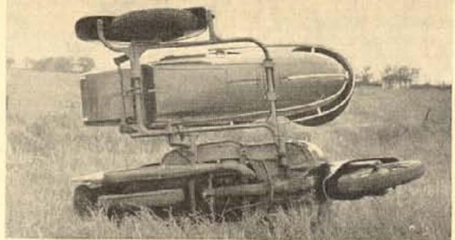
Royal an Maicoletta von unten gesehen. Zwei Kugelgelenke bilden die Verbindung mit dem Rahmen. Eine dritte Verbindung geht schief hoch und ist oben durch die Karosserie ebenfalls am Rahmen geschraubt. (Karosserie kann trotzdem entfernt werden!)
