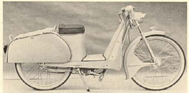
In den beiden Kästen der Hinterradverkleidung kann Kleingeepäck wetter-, staub- und diebstahlsicher untergebracht werden
