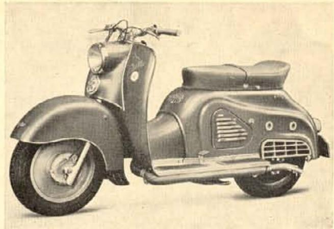
Motor 150 cm mit 7 PS bzw. 200 cm mit 10 PS. Als Anlasser oder Kickstartermodell lieferbar. Große 19"-Leichtmetallscheibenräder, Kühlung durch geleiteten Fahrtwind und thermische Luftströmung
